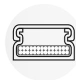
Canaleta con tapa frontal y montaje superficial sobre pared o techo para la distribución de cables en instalaciones eléctricas y de comunicaciones.
